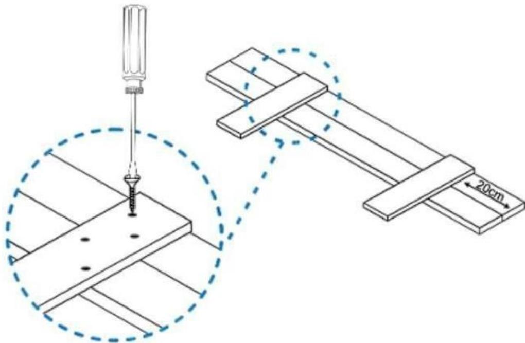
Postavite kratku pločicu na razmak od 7,5 cm tako da manjski rub male ploče bude u isto vrijeme sa vanjskim rubom duge ploče. Na taj način će cijela konstrukcija biti zaščitena od slučajne samomontaže. Sada su 2 elementi prikazani u nastavku.
